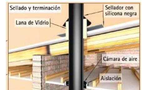
❗ **ENCAMISADO:** Se deberá instalar un doble conducto o encamisado, en el sector donde se atraviesa el techo (y de requerir también, en el entre techo) evitando así el contacto directo del conducto caliente con materiales combustibles.
