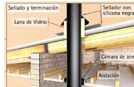
• La babetas se debe soldar al encamisado según la pendiente del techo, evitando la filtración de agua de lluvia.
