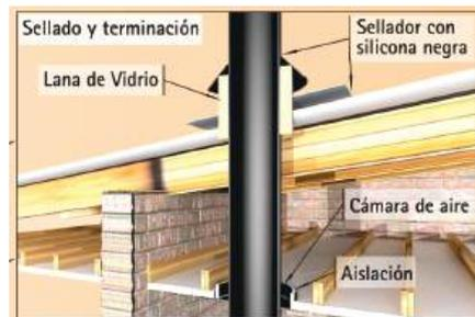
① **ENCAMISADO:** Se deberá instalar un doble conducto o encamisado, en el sector donde se atraviesa el techo (y de requerir también, en el entre techo) evitando así el contacto directo del conducto caliente con materiales combustibles.
