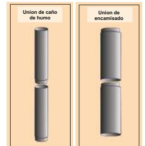
**⚠ AISLACION:** Entre el conducto y el encamisado se debe colocar un aislante resistente como lana mineral, lana de vidrio o manta de fibra cerámica para lograr una adecuada aislación.
