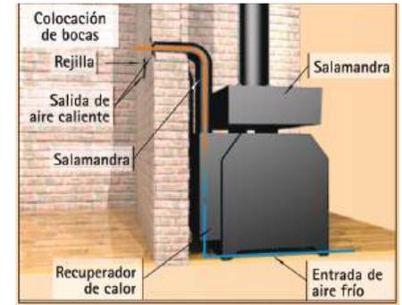
**ⓘ** Para la conexión, se utiliza caños y/o codos de 4", de chapa galvanizada o corrugado de aluminio.
