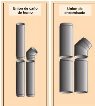
**⚠** En caso de no encamisar todo el caño que sobresale en el exterior, se debe sellar las uniones con silicona acética para evitar filtración de agua por el interior del conducto.
